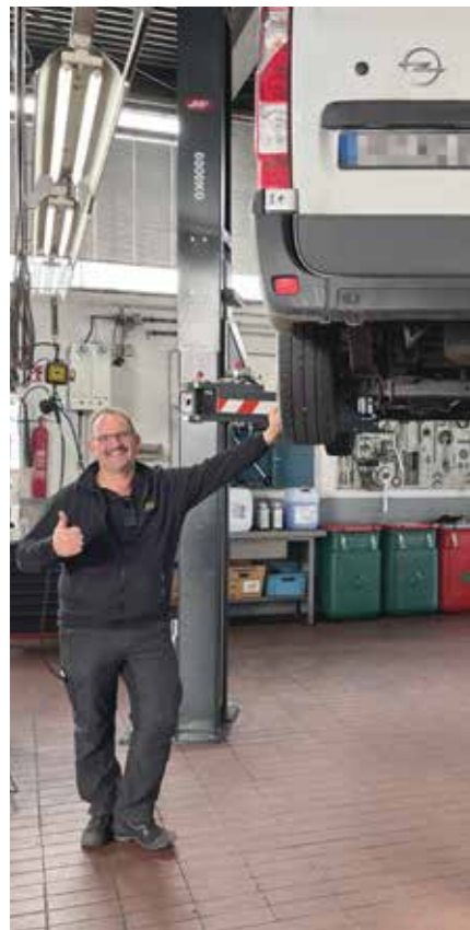
Michael Hahn bestellte die Bühne auch, um Rettungswagen zu heben. Das neue JMP-Modell verfügt über so genannte Flex-Arme. Diese lassen sich im ausgefahrenen Zustand noch einmal wegnicken, um sämtliche Aufnahmepunkte zu erreichen.
