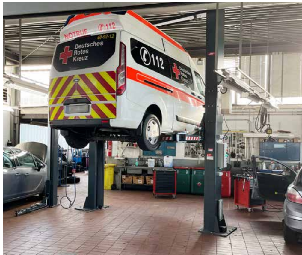
Michael Hahn bestellte die Bühne auch, um Rettungswagen zu heben. Das neue JMP-Modell verfügt über so genannte Flex-Arme. Diese lassen sich im ausgefahrenen Zustand noch einmal wegnicken, um sämtliche Aufnahmepunkte zu erreichen.
