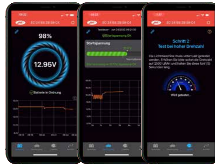
Übersichtliche Darstellung: Messung des Batteriezustands (l.), der Startspannung (M.) – oder ein Test bei hoher Drehzahl.
