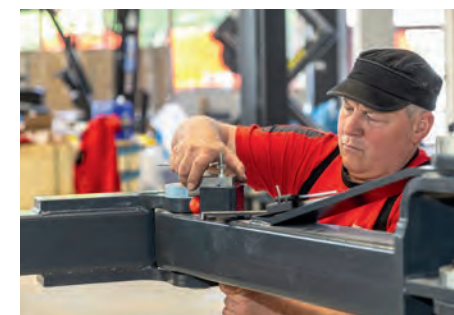
Jeder Handgriff sitzt: Hier installieren die Techniker die Zweisäulen-Bühne JMP Fox 6000 FA. Mit ihren Flex-Armen (FA) können sämtliche Aufnahmepunkte bequem erreicht werden.
