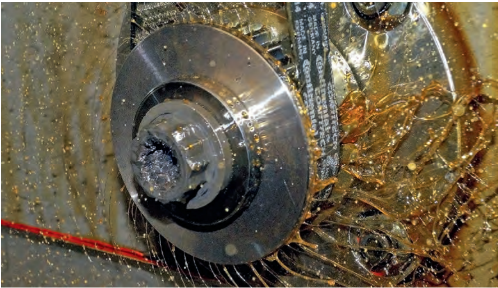
„Nasser“ Zahnriemen: Ursprünglich als fortschrittliche Lösung zur Effizienzsteigerung und Geräuschreduzierung entwickelt, hat sich das sogenannte Belt-in-Oil-System in der Praxis jedoch als schwierig erwiesen. Vorzeitiger Verschleiß und Ablagerungen im Öl können zu teuren Reparaturen und sogar Motorschäden führen.
