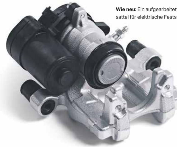
**Wie neu:** Ein aufgearbeiteter Brems-sattel für elektrische Feststellbremsen.
