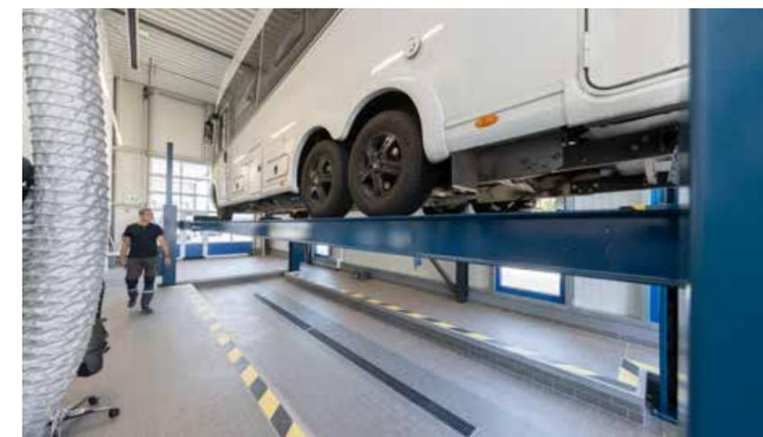
**Extralang:** Diese 12-Tonnen-Bühne steht in der Dialogannahme. Hier erledigen die Monteure alles, was Einträge erfordert – etwa Hauptuntersuchungen, Dichtigkeits- und Gasprüfungen.
