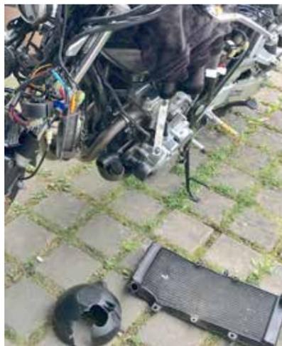
**Autsch:** Undichter Wasserkühler einer Honda CB 1300. Kompatiblen Ersatz gibt's von JMP.
