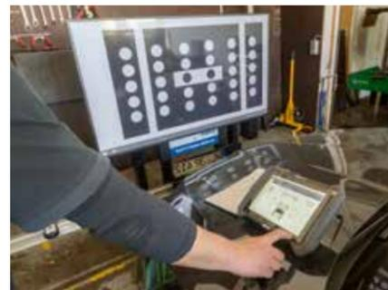
**Praktisch:** Das Kalibriertarget wird auf dem Bildschirm angezeigt. Die Bedienung erfolgt per mitgeliefertem Diagnosetester.
