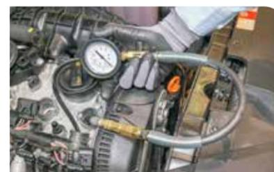
**Druckverlust effektiv prüfen**
