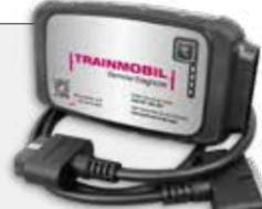
Remote Service von Matthias und Trainmobil zurück. Mithilfe der Remote Box (einfach in die OBD-Dose stecken) wählen sich die Techniker von Trainmobil via Internet aufs Fahrzeug und erledigen die kniffligen Aufgaben von außen. Der große Vorteil: Die Hamburger Experten verfügen über alle gängigen Tester und haben Zugriff auf mehr als 40 Herstellerportale. Die Diagnose-tiefe ist also gewährleistet. Der Mitarbeiter im Betrieb muss
