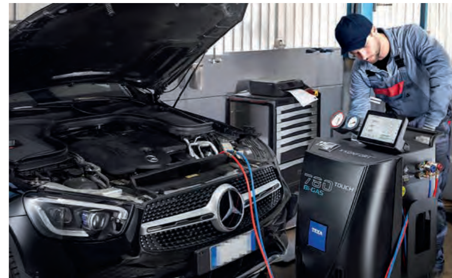
Vollautomatisches Dualgerät: Das Texa-Klimaservicegerät nutzt zwei Tanks und doppelte Kreisläufe. So können Betriebe Kundenfahrzeuge für beide Kältemittel bedienen.
