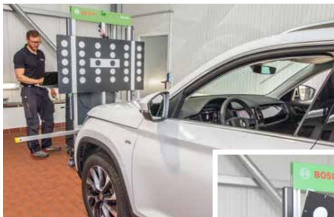
Timo Kretzschmar vom Autohaus am Sachsenwald bereitet eine Kalibrierung mit dem DAS 3000 vor. Speziell die unkomplizierte Ausrichtung überzeugt viele Betriebe.
