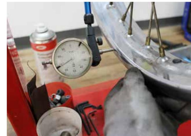
Das Zentrieren der Felge kann mühselig sein. Bei einem Komplettträger spart sich der Schrauber diesen Arbeitsschritt.
