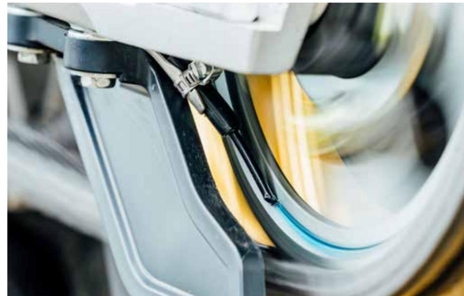
Hersteller **Scottoiler** nennt sein eSystem V3.1 „das fortschrittlichste elektronische Kettenöl-system der Welt“. Das Multifunktionsdisplay (u.) wird direkt am Lenker angeschlossen. So lässt sich die Öldurchflussmenge mühelos einstellen.
