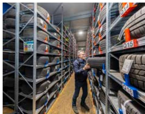
Von unten kaum erkennbar: In der neuen Halle hat Peschel ein hochmodernes Reifenlager gebaut. Die Räder werden per Lift nach oben gebracht, dort wartet ein Reifenheber. „So ist kaum körperliche Anstrengung notwendig.“ Im Regal rutschen die Reifen automatisch nach.
