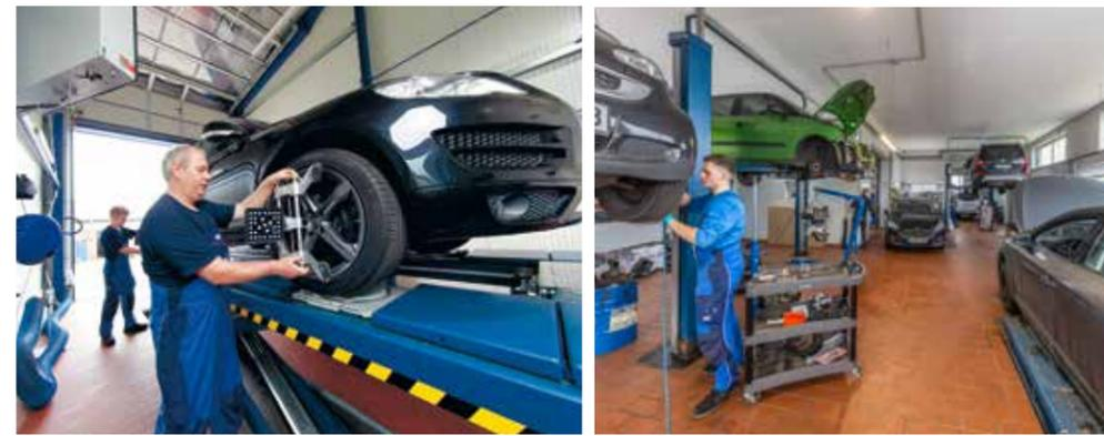
Bestens ausgestattet: Insgesamt 13 Bühnen stehen im Betrieb. Auch drei Klimageräte, mehrere Reifenmaschinen, ein Kalibriertool sowie die 3D-Achsmessanlage (l.) gehören zum Equipment.
