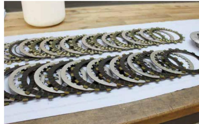
Mit bloßem Auge erkennbar: Vorne die alten Kupplungslamellen, deren Mindestmaß deutlich unterschritten ist. Dahinter zum Vergleich: der neue Reparatursatz.
