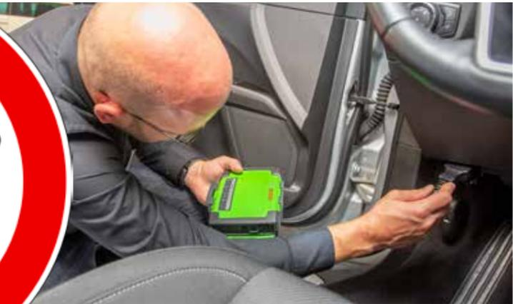
Mit aktuellen Diagnosemodulen wie dem Bosch KTS 590 (Bild) können Werkstätten an „geschützten“ Fahrzeugen arbeiten. Auch bei Hella Gutmann klappt dies nach einem Update.
