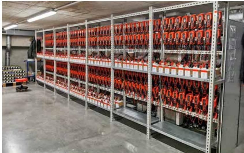
Ein Blick hinter die Kulissen. Nach dem Wareneingang wird die Kapazität der gefüllten Batterien getestet und gegebenenfalls nachgeladen.
