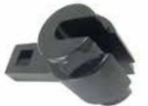
**JMP Gabelschlüssel für Big-Piston-Gabeln.** Zum Aus- und Einbau des Stangenführungsgehäuses aus dem inneren Gabelschaft bei Big-Piston-Gabeln. Mit zwei Größen – für Kawasaki und Suzuki. Abmessungen (Sechskant): 32,8 mm / 34,7 mm, Antrieb: 1/2".
