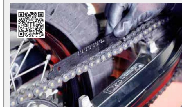
Mithilfe dieser Kettenprüflehre von JMP lassen sich schnell die Kettenlängung und -spannung prüfen. Eine Skala an der Spitze dient zur Messung der Längung (bis zu 2 %). Liegt der Wert über 1 %, empfiehlt sich ein Austausch. Um die Kettenspannung zu kontrollieren, muss die Herstellervorgabe bekannt sein. Jetzt das Werkzeug an die Schwinge legen, Kette hochdrücken und Wert ablesen. Eignet sich für 420er- bis 530er-Ketten. Auf der Produktseite (QR-Code) findet sich auch ein Anwendungsvideo.
