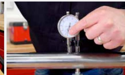
**Gekrümmt oder gerade?** Eine Antwort liefert dieses JMP-Prüfwerkzeug. Einfach das Rohr auflegen und drehen. So stellen Monteur geringste Abweichungen fest. Das Tool verfügt über eine Hebelanzeige (rechts). Beim radialen Drehen sollte der Zeiger nicht mehr als 0,05 mm ausschlagen. Falls dies passiert, befindet sich das Rohr außerhalb der Toleranzgrenze, und es empfiehlt sich der Austausch. Durch
