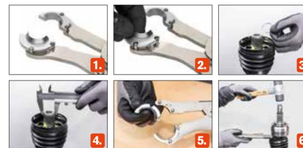
**Einfache Anwendung:** Passende Halbschalen je nach Wellendurchmesser in Zange einsetzen. Das Tool danach auf Verzahnung mit vormontiertem Sicherungsring setzen und spannen. Die Vorpositionierung des Gelenks durch konische Formgebung der Zange ermöglicht einfachere Einführung der Verzahnung ohne Beschädigungen.
