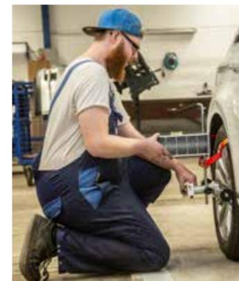
Präzises Vorgehen: Vor der Einstellung mit dem CSC-Tool muss bestätigt werden, dass die Achsgeometrie in Ordnung ist. Eine Achsvermessung ist daher auf jeden Fall sinnvoll und zu empfehlen.
