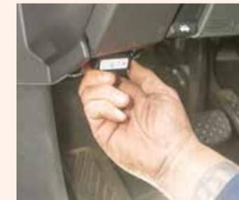
Sobald der Dongle in die OBD-Dose eingesteckt und per Bluetooth verbunden ist, funkt er ständig Informationen. Eine echte Daten-Goldgrube für Kfz-Betriebe. Wichtig: Nur die Werkstatt (!) erhält bei Störungen den entsprechenden Fehlercode.
