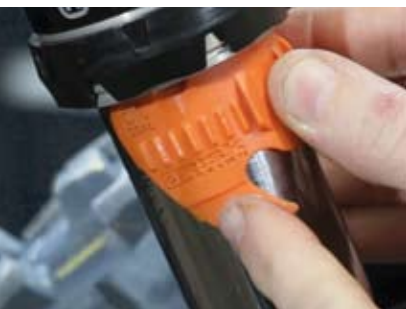
Unter den Simmerring schieben, dann vorsichtig drehen.
