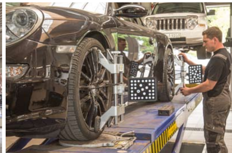
Probleme an der Radaufhängung des Oldtimers (l.), Achsvermessung beim Porsche (r.): Die zwei Beispiele zeigen, wie breit sich die freie Werkstatt aufgestellt hat. Die berühmten „Reparaturen aller Art“ – hier wird der Slogan gelebt. Bis hin zu Wohnmobilen.
