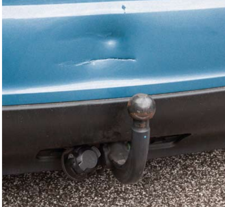
Ärgerlicher Riss: Doch nicht immer muss das kaputte Teil ersetzt werden. Wie hier beim Stoßfänger reicht auch die Reparatur.
