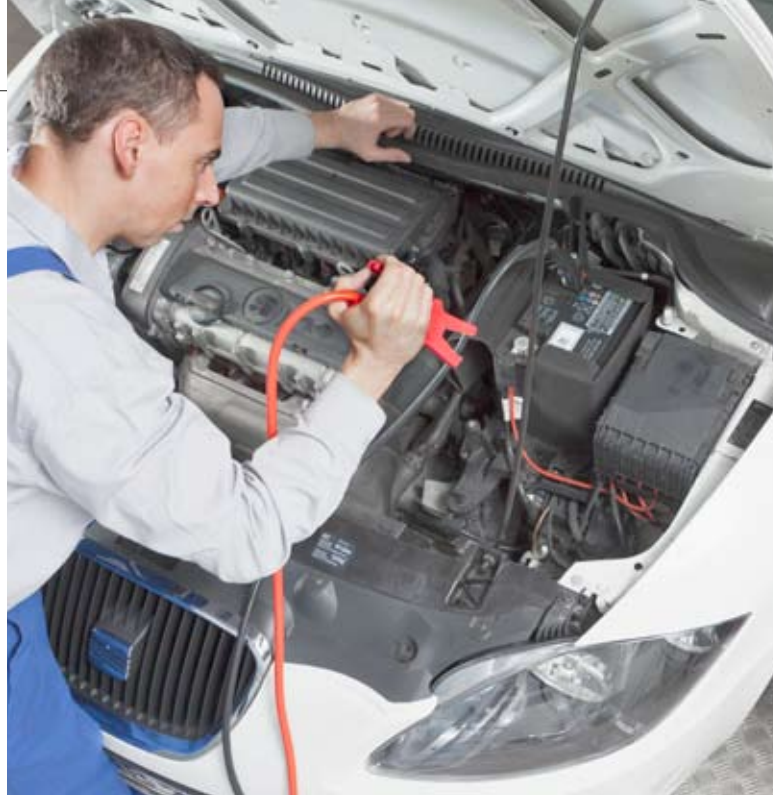
Wichtig: Welcher Batterietyp ist verbaut? Eine Blei-Säure-Batterie kann beispielsweise keine AGM-Batterie ersetzen.
