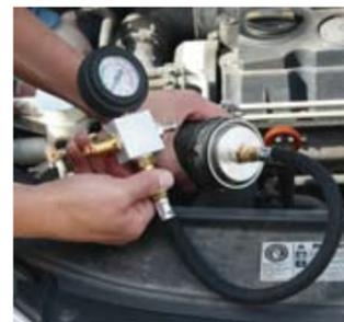
**Ladeluftsystem-Prüfkoffer:** Untersucht den Überdruck-Kreis auf Undichtigkeiten.
