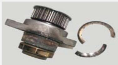
**Bordscheibe abgerissen:** Fluchtfehler im Riementrieb, der Zahnriemen läuft stark seitlich an.
