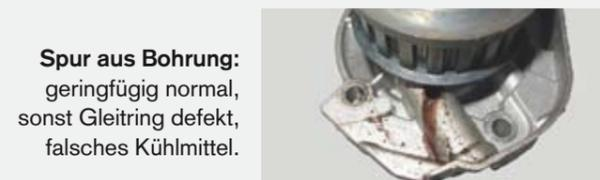
**Spur aus Bohrung:** geringfügig normal, sonst Gleitring defekt, falsches Kühlmittel.
