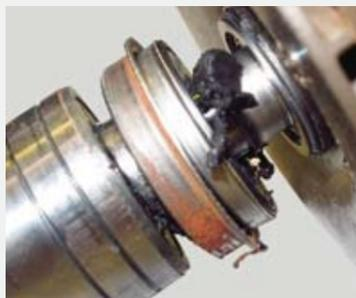
**Zu viel Dichtmasse:** verstopft das System, beschädigt die Gleitringdichtung, bewirkt letztlich das Gegenteil – Kühlmittelverlust.
