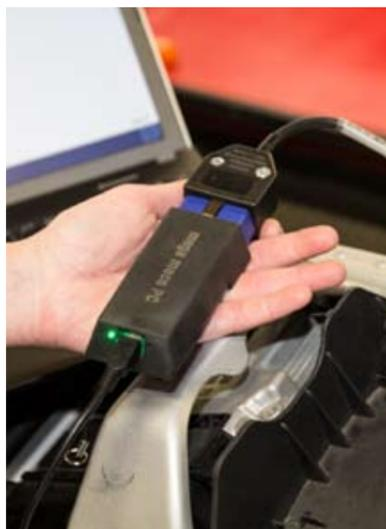
**Adapter erforderlich: Erst ab Baujahr 2017 verfügen Motorräder über eine genormte OBD-Dose.**
