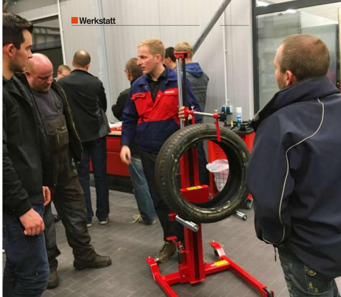
Vorsprung durch Technik: Statt Muskelkraft positioniert der Radmontagelift das Rad (hier symbolisiert) millimetergenau. Macht Sinn vor allem im UHP- und SUV-Segment, wo ein Rad inzwischen über 30 Kilo wiegen kann – und ist preiswerter als ein einziger Ausfalltag eines Mechanikers wegen Rücken.
