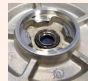
**Eingefräst:** Das vergrößerte Seitenspiel der Welle hat die Dichtbuchse zerstört.
