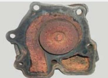
**Starke Korrosion:** falsches, zu wenig Kühlmittel oder pures Wasser im System. Pumpe erneuern.
