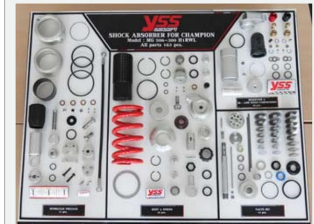
High-End-Federbein: Einzelteile des YSS-Topmodells MG 506 H1RWL in Baugruppen sortiert. Nur das Öl fehlt.
