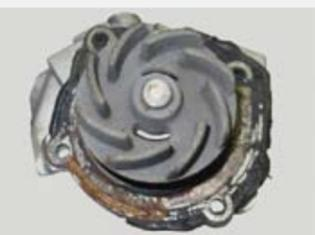
**Gehäuse undicht:** falsche Pumpe, Dichtflächen verschmutzt oder beschädigt, zu viel oder ungeeignete Dichtmasse.
