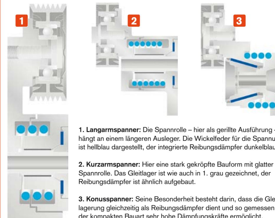
**1. Langarmspanner:** Die Spannrolle – hier als gerillte Ausführung – hängt an einem längeren Ausleger. Die Wickelfeder für die Spannung ist hellblau dargestellt, der integrierte Reibungsdämpfer dunkelblau.
