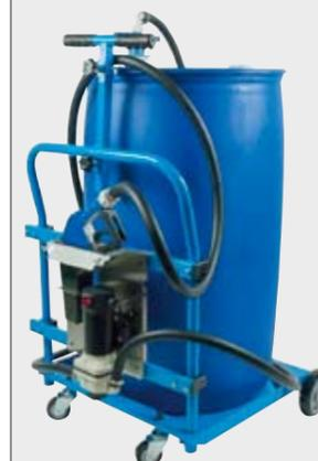
Befüllstation mit sechs Meter Füllschlauch für schlecht erreichbare Inntanks. Für 60- und 200-l-Gebinde, Elektropumpe 10 l/Min., Automatik-Zapfpistole mit Zählwerk sowie einem Auslauf aus Edelstahl.
